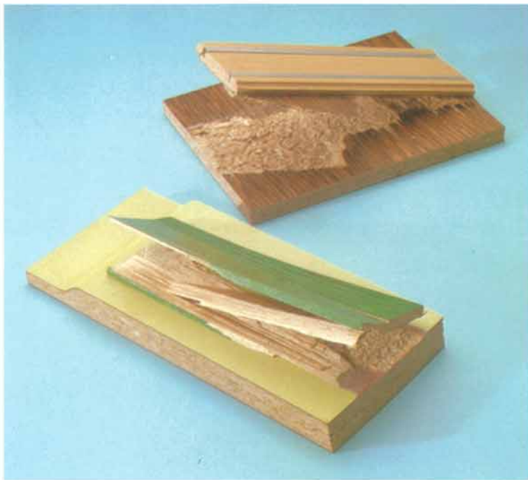
Der Materialbruch zeigt die optimale Haftung von KLEIBERIT Super-Lackleim 308 auf Kunststoff- sowie Lackoberflächen.
